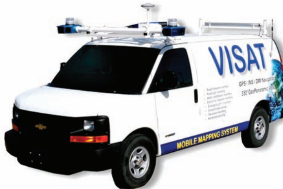
Figure 7.3. VISAT™ Van Mobile Mapping System. (N. El-Sheimy, see page 94)
